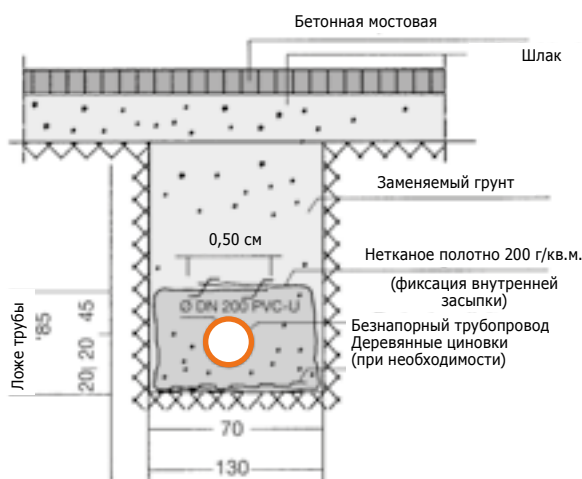
Рис. 7 Пример прокладки труб в мягком грунте
